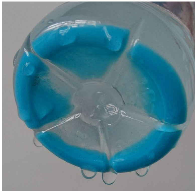
Slika 3.2 Uzorak zeolita A nakon sorpcije
