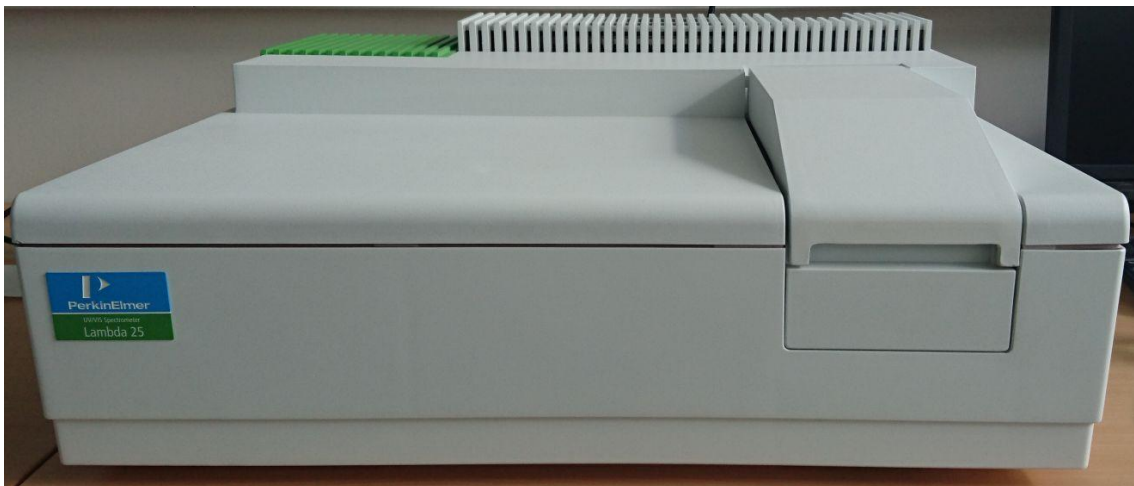
Slika 2.4 Spektrofotometar Perkin Elmer Lambda 25.
