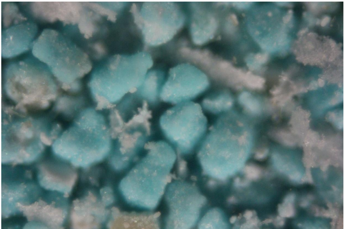
Slika 3.4 Mikroskopski snimak ljuskica jaja nakon sorpcije pri uvećanju 200x
