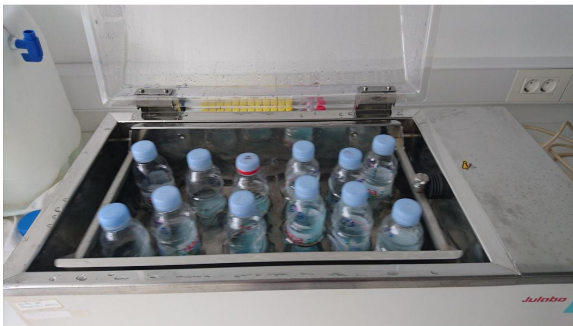
Slika 2.12 Reaktori u tresilici
