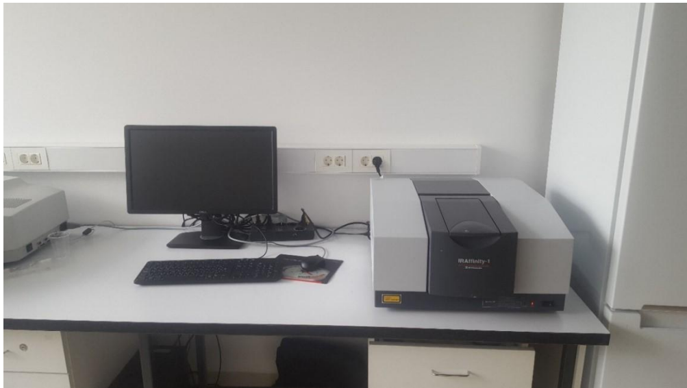
Slika 2.7 FTIR IRAffinity-1 Shimadzu
