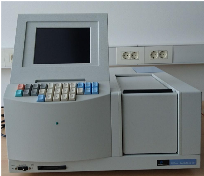
Slika 2.4 Spektrofotometar Perkin Elmer Lambda EZ 201
