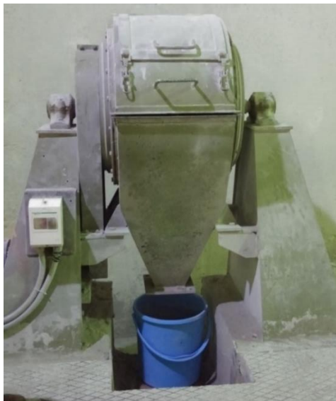
Slika 6. Prikaz poluindustrijskog horizontalnog mlina s čeličnim kuglama [14]
