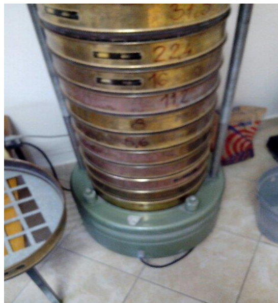
Slika 23. Garnitura sita za određivanje granulometrije klinkera
