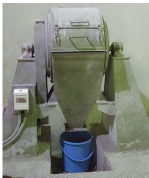
Slika 27. Prikaz poluindustrijskog horizontalnog mlina s čeličnim kuglama
