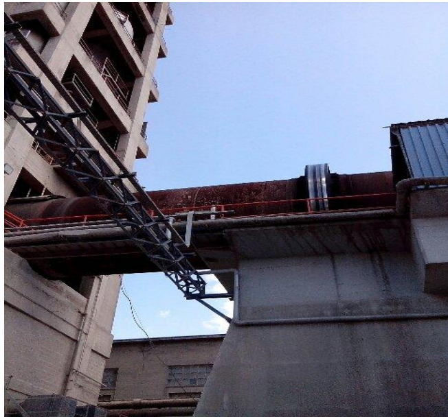
Slika 7. Prikaz početka rotacijske peći u postrojenju sv. Kajo
