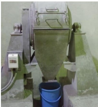
Slika 3. Prikaz poluindustrijskog horizontalnog mlina s čeličnim kuglama [11]
