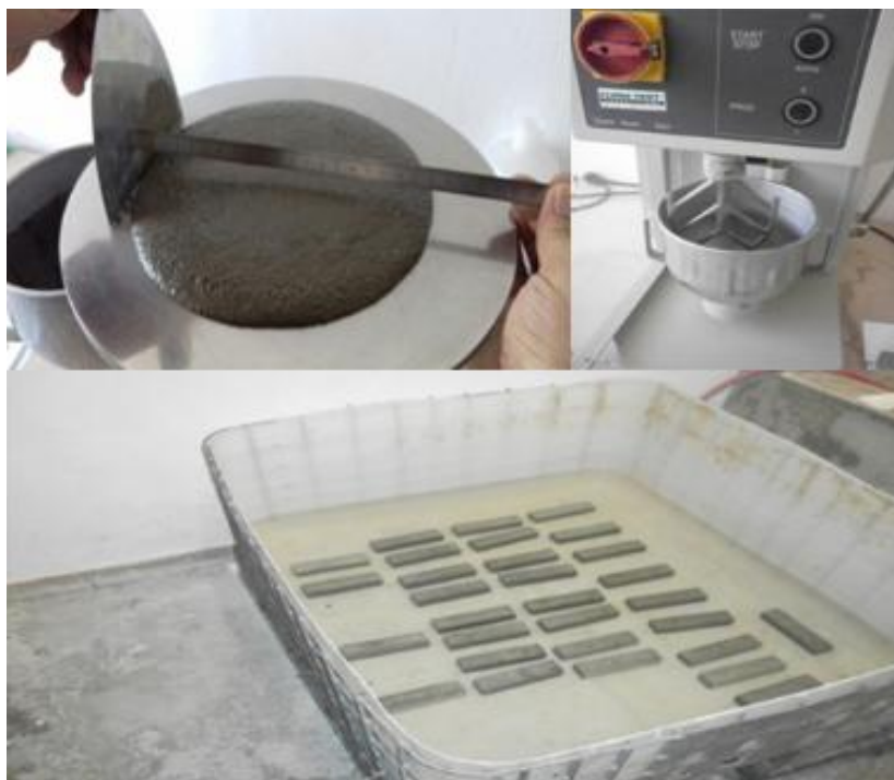
Slika 5. Priprema cementnih mortova (konzistencija (gore lijevo), miješanje (gore desno) i njegovanje (dolje) mortova)
