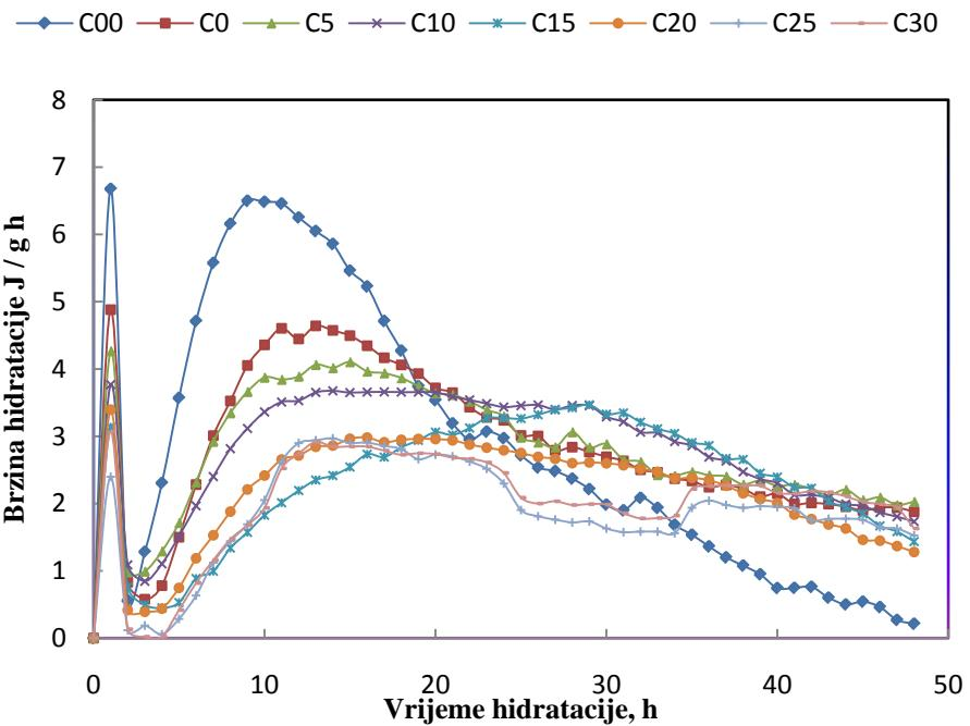
**Slika 10.** Ovisnost brzine oslobođanja topline o vremenu hidratacije cementnih uzoraka uz masene udjele otpadne građevinske opeke 0-30% s 0,3% plastifikatora "Aquarex direct"
