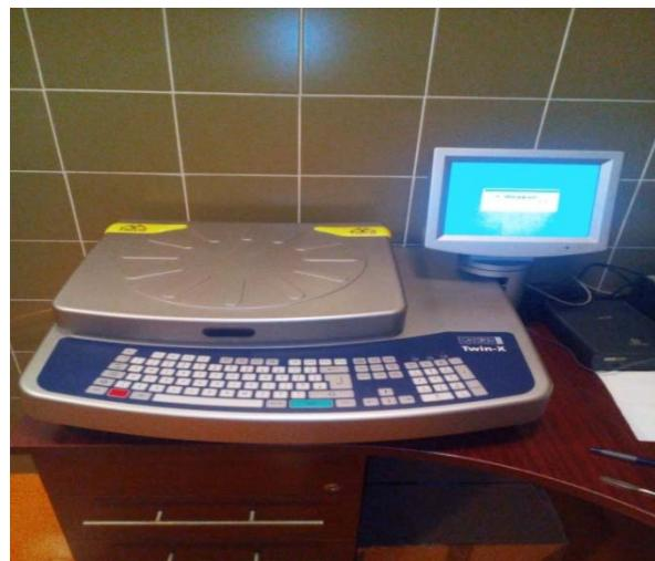
**Slika 5.** EDXRF uređaj za kvantitativnu analizu
