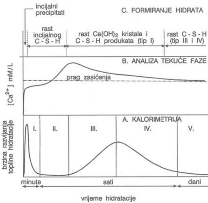
**Slika 3.** Shematski prikaz hidratacije portland cementa<sup>2</sup>
