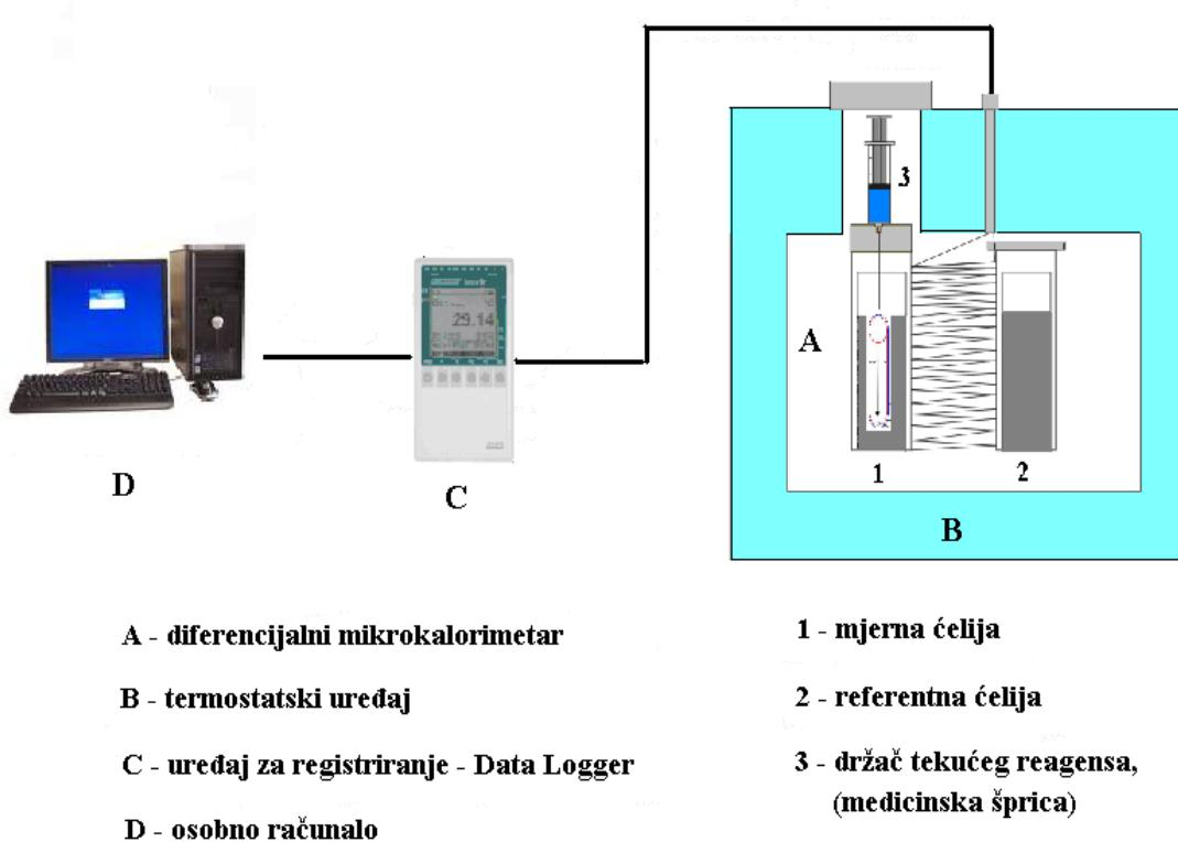
**Slika 7.** Aparatura za praćenje oslobođene topline hidratacije<sup>3</sup>
