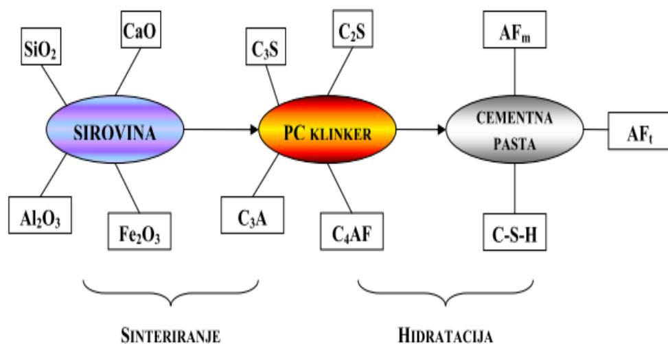
**Slika 1.** Shematski prikaz promjene oblika tijekom pečenja i hidratacije dobivenog portland cementa<sup>3</sup>
