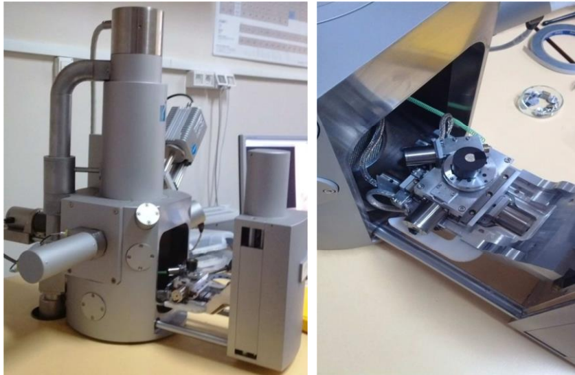
Slika 23. Pretražni elektronski mikroskop Tescan Vega TS5136LS
