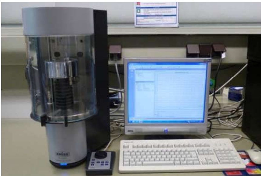
Slika 13. Uređaj za mjerenje napetosti površine Force Tensiometer – K100 (Krüss GmbH, Hamburg, Njemačka)
