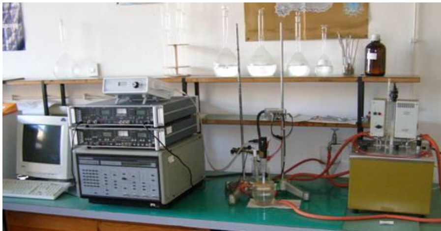
Slika 6. Aparatura za provedbu elektrokemijskih mjerenja
