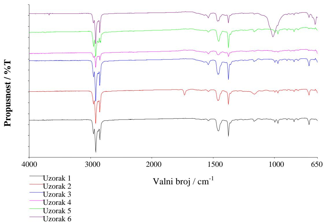
**Slika 3.29.** FTIR spektrogrami svih uzoraka poliolefinskih materijala
