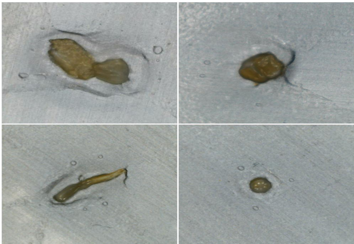
Slika 3.17. Prikaz ispitivanih gelova s površine kompozitnog materijala snimljen USB mikroskopom
