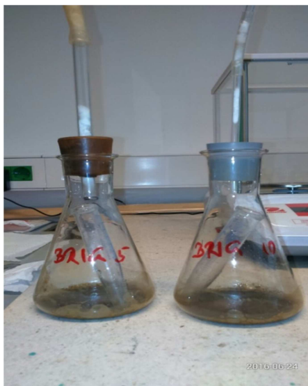
Slika 10. Određivanje karbonata u sedimentu gravimetrijskom metodom
