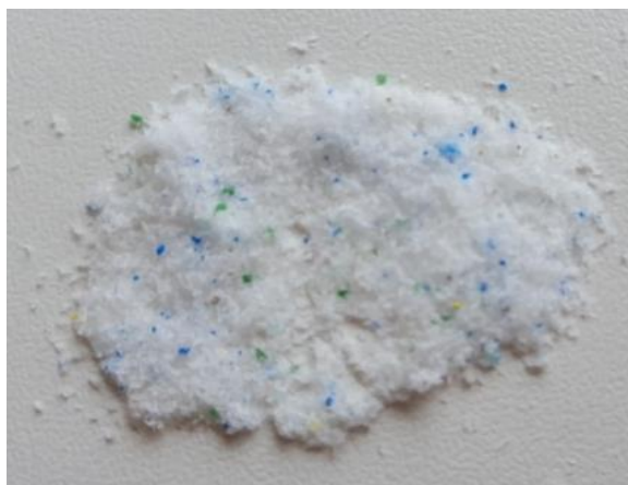
Slika 7. Samljevene granule polilaktidne kiseline s vidljivim nečistoćama
