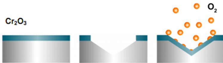
Slika 20. Prikaz mehanizma samo obnavljanja pasivnog filma kromovih oksida na površini.<sup>36</sup>
