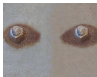
Slika 21. Primjer galvanske korozije čelika<sup>48</sup>
