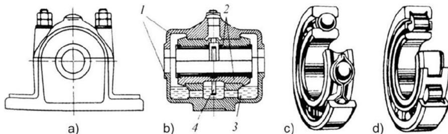
Slika 12. Ležaj a) i b) radikalni klizni, c) kuglični, d) valjkasti;
