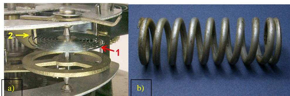
Slika 11. a) Spiralna opruga na nemirnici sata, b) tlačna zavojna torzijska opruga<sup>22</sup>
