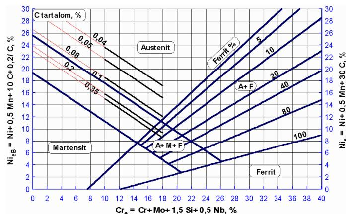
Slika 16. Schaefflerov dijagram koji prikazuje kako struktura nehrđajućih čelika ovisi o omjerima krom i nikal-ekvivalentnih legirajućih elemenata<sup>31</sup>
