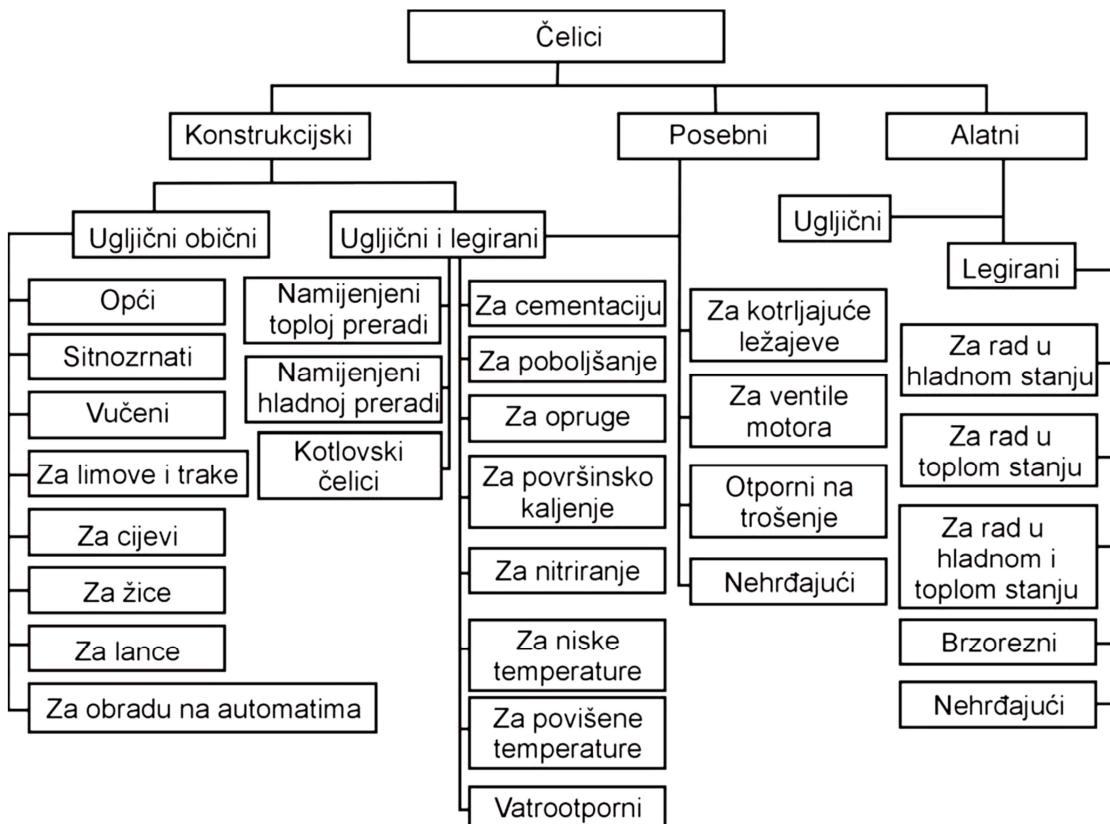
Slika 3. Podjela čelika prema namjeni.<sup>9</sup>
