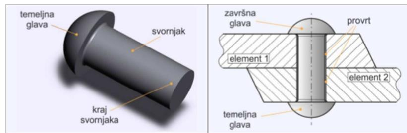
Slika 26. Dijelovi zakovice i izvedeni zakovični spoj<sup>65</sup>
