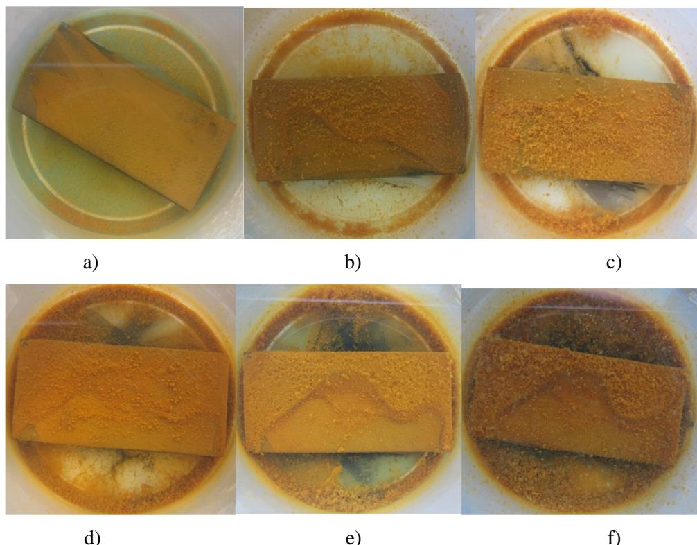
Slika 19.Čelični uzorak uronjen u deioniziranu vodu nakon a) 48 h, b) 72 h, c) 144 h, d) 216 h, e) 312 h i f) 480 h.<sup>40</sup>
