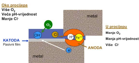
Slika 22. Shematski prikaz odvijanja korozije u pukotini
