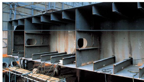
Slika 10. Brodograđevni čelik ugrađen u sekciju broda<sup>21</sup>
