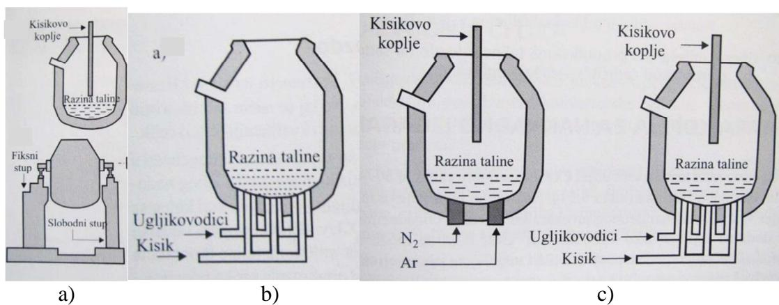
Slika 5. Konvertori za proizvodnju čelika s propuhivanjem kisika odozgo a), odozdo b) i kombinirano c)<sup>1</sup>
