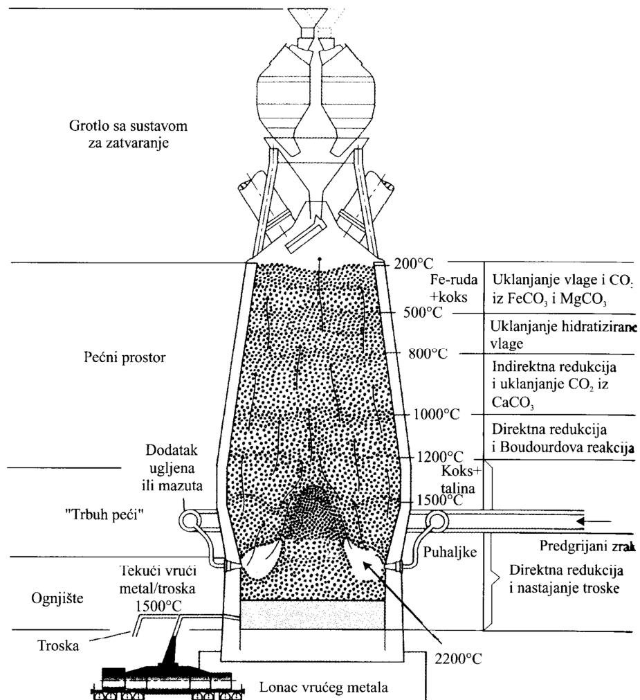
Slika 4. Shematski prikaz poprečnog presjeka i temperturni profil visoke peći.<sup>1</sup>
