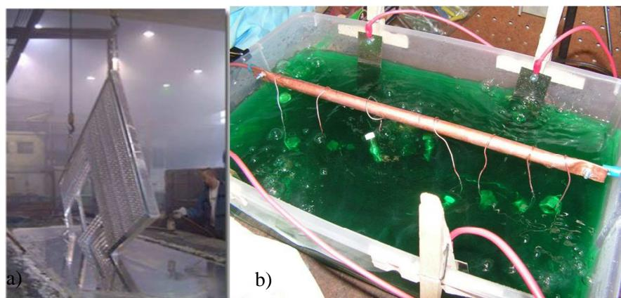
Slika 24. Zaštita čeličnih predmeta a) vrućim pocinčavanjem<sup>50</sup> b) niklovanjem<sup>51</sup>
