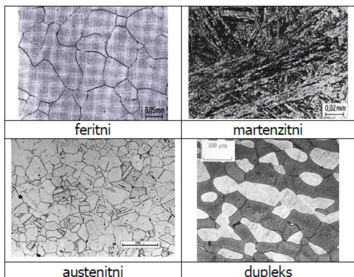
Slika 17. Karakteristične mikrostrukture pojedinih grupa nehrđajućih čelika<sup>36</sup>
