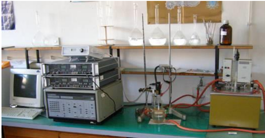
Slika 11. Aparatura za provedbu elektrokemijskih mjerenja.
