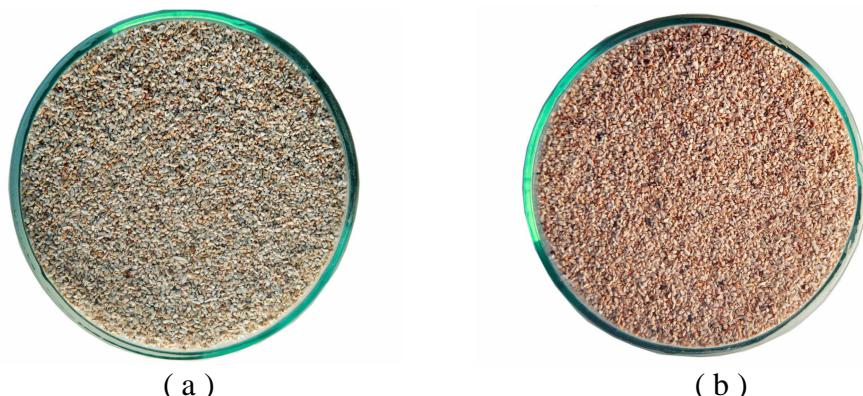
Slika 2.1. Usporedba prirodnog (a) i Fe(III)-modificiranog zeolita (b).
