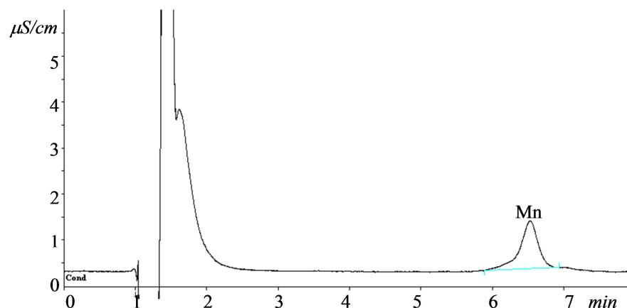
Slika 2.2. Primjer kromatograma određivanja mangana.
