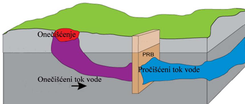
Slika 1.4. Izvedba permeabilne reaktivne barijere.<sup>17</sup>
