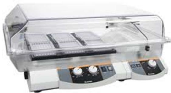
**Slika 2.3.** Laboratorijska tresilica "Heidolph unimax 1010".
