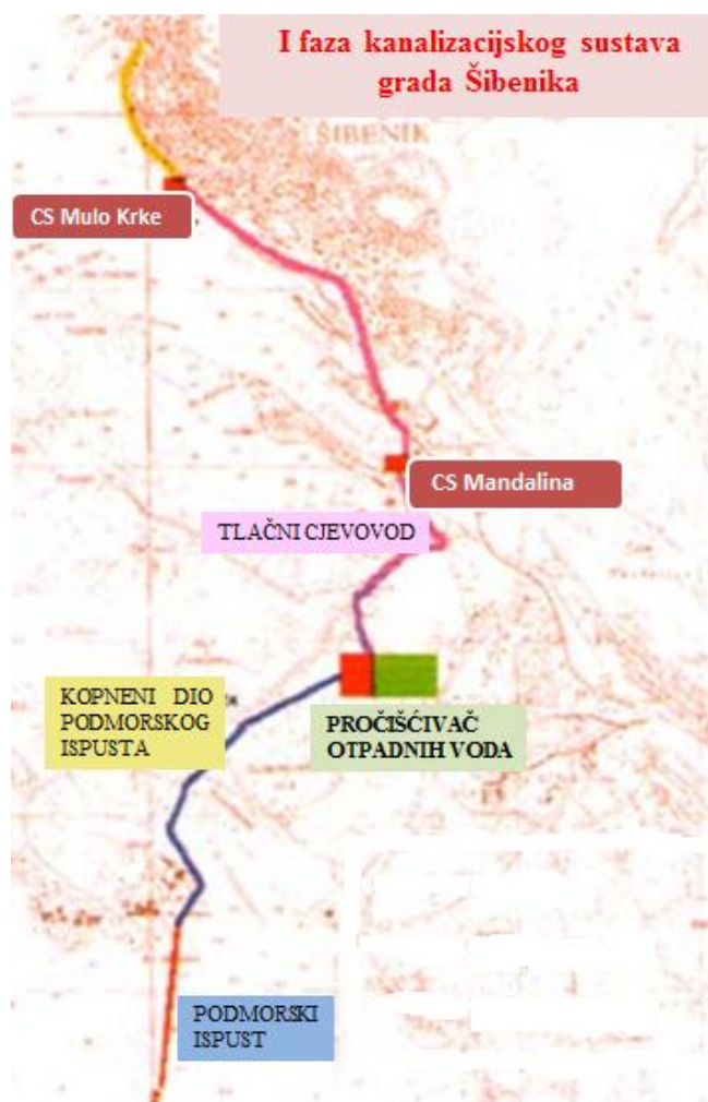
Slika 1.4. Shema kanalizacijskog sustava Šibenika 12 .
