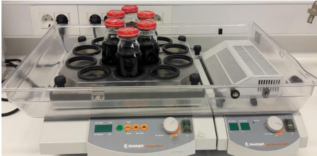
Slika 2.5. Provedba obrade kompozitnog uzorka procjedne vode sa zeolitom šaržnim postupkom.
