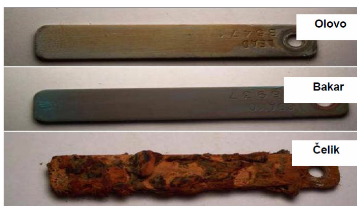
Slika 2.6. Izgled korodiranih dijelova različitih metala koji su bili izloženi djelovanju istih elektrolita 31 .
