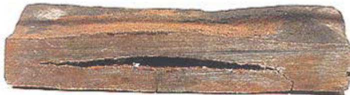
Slika 2.10. Vodikova bolest ugljičnog čelika 32 .
