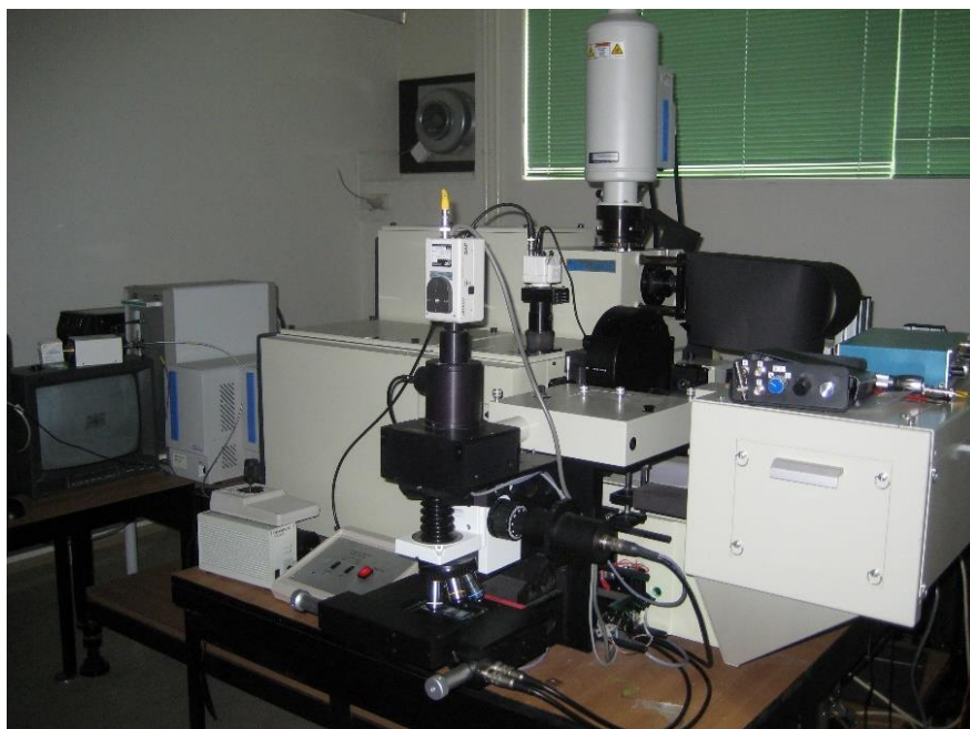
Slika 23. Ramanov spektrometar, Horiba Jobin Yvon, model T64000, Laboratorij za molekulsku fiziku Zavoda za fiziku materijala Instituta Ruđer Bošković u Zagrebu
