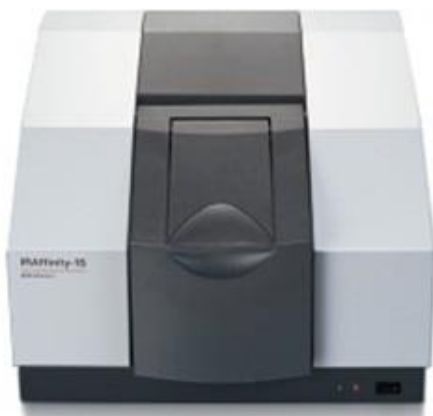
Slika 26. FTIR Shimadzu IRfinity1, Zavod za organsku kemiju Kemijsko-tehnološkog fakulteta Sveučilišta u Splitu
