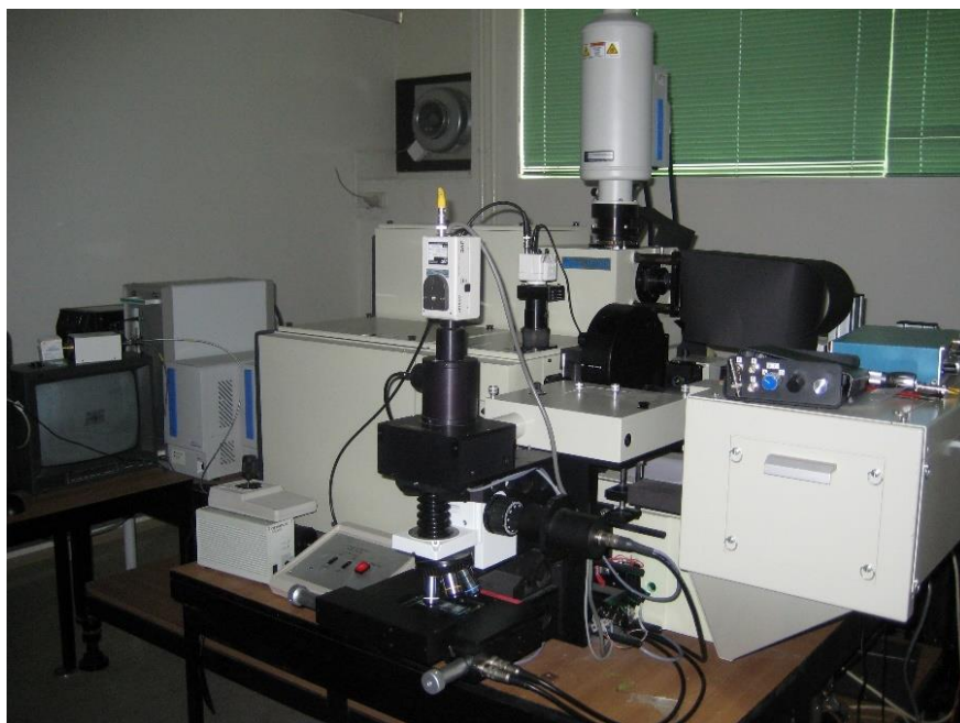
Slika 23. Ramanov spektrometar, Horiba Jobin Yvon, model T64000, Laboratorij za molekulska fiziku Zavoda za fiziku materijala Instituta Ruđer Bošković u Zagrebu
