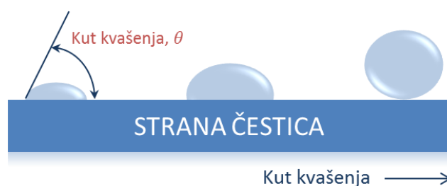
Slika 7. Kut kvašenja strane čestice.
