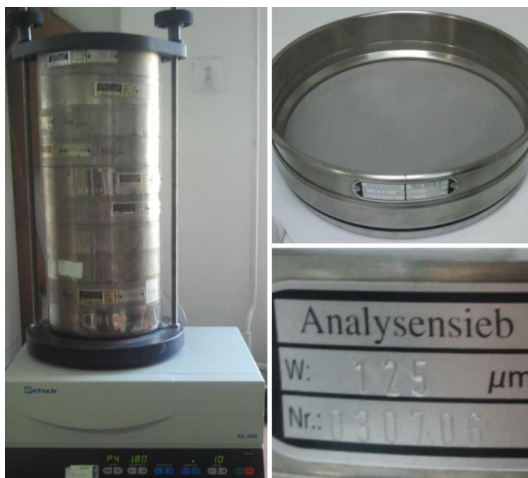
Slika 39. Aparatura za provedbu granulometrijske analize prosijavanjem.
