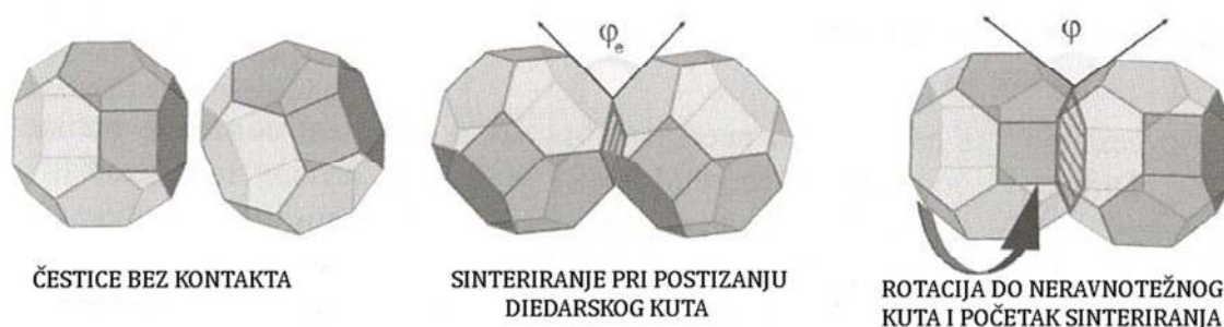
Slika 2.11. Shematski prikaz početka sinteriranja nesfernih čestica. 39
