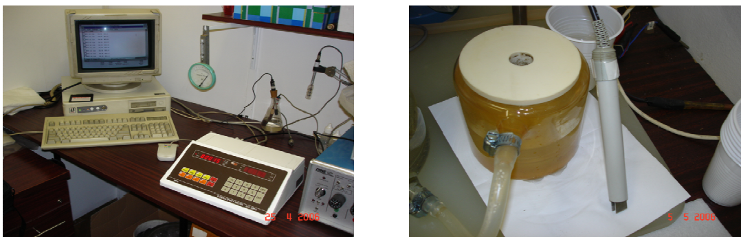
Slika 26. Aparatura za konduktometrijska mjerenja
