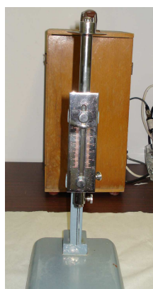
Slika 23. Vicatov aparat za određivanje normalne konzistencije i vremena vezivanja
