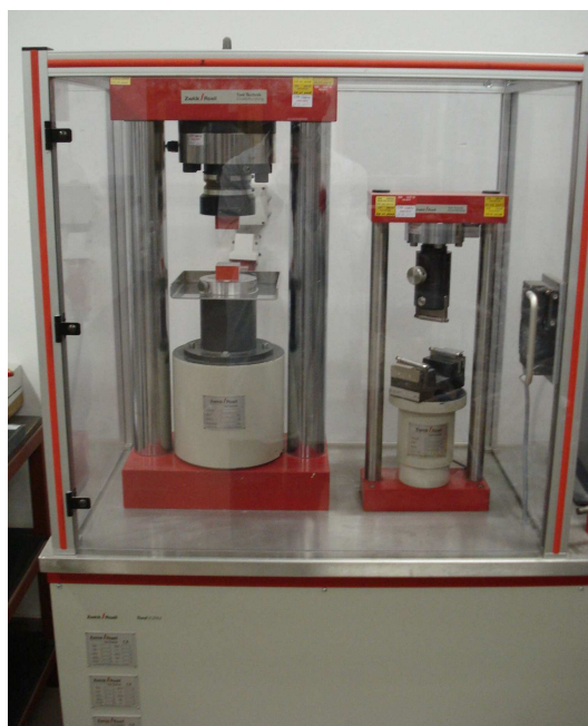
Slika 29. Sustav hidrauličnih preša za određivanje tlačne i savojne čvrstoće
