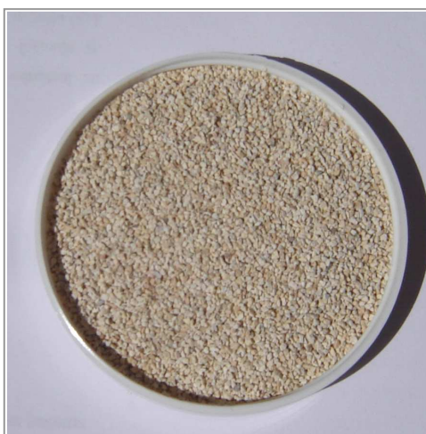
Slika 3.1. Uzorak prirodnog zeolita veličine čestica 0,6 - 0,8 mm.
