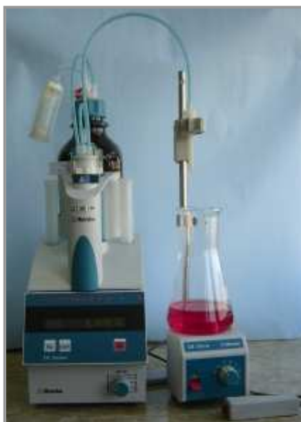
Slika 3.4. Titrator Metrohm 775 Dosimat.
