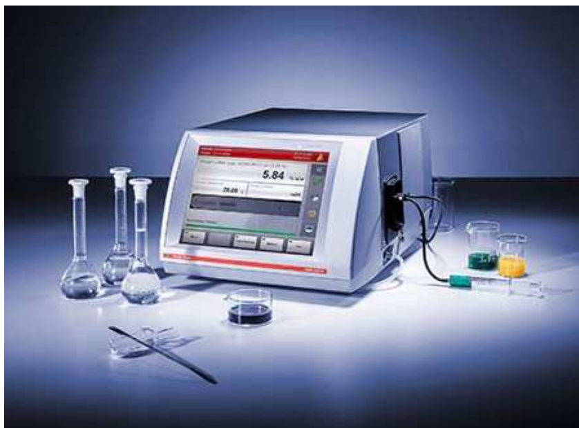
Slika 22. Mjerač gustoće DMA 4500M (Anton Paar)
