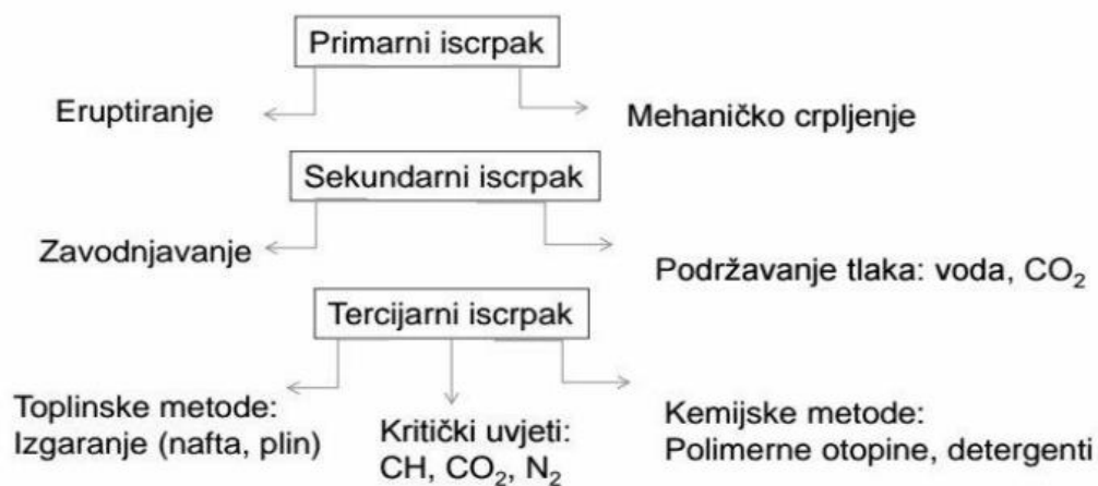
Slika 1.2. Shema ukupnog procesa crpljenja nafte iz ležišta. 1
