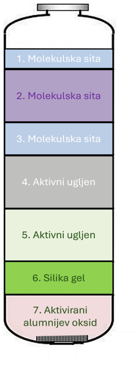
Slika 18. Prikaz adsorpcijske kolone sa slojevima adsorbensa na 380-PSA2
