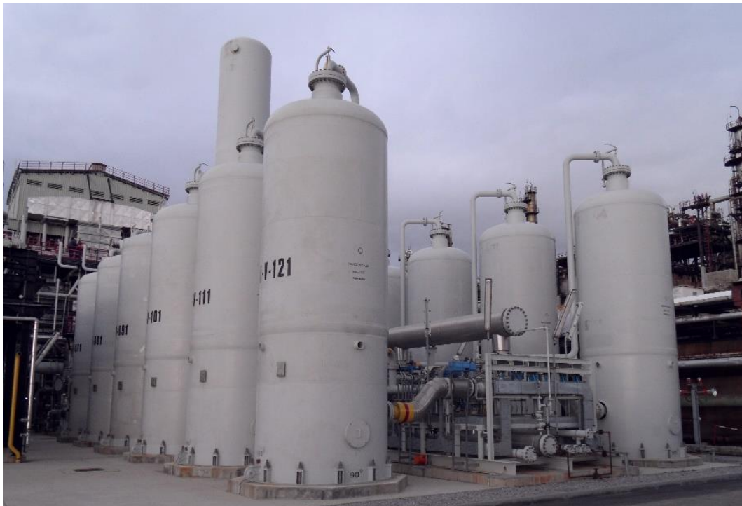
Slika 16. Adsorpcijske kolone na 380-PSA2 jedinici 17
