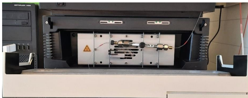
Slika 8. Kolona u termostatiranom prostoru.
