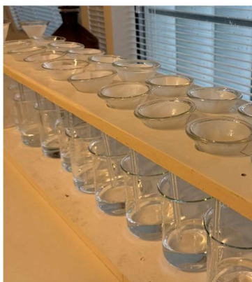
Slika 12. Filtracija magnezijeva hidroksid.
