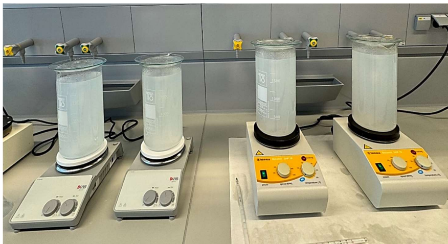
Slika 11. Taloženje magnezijeva hidroksida.
