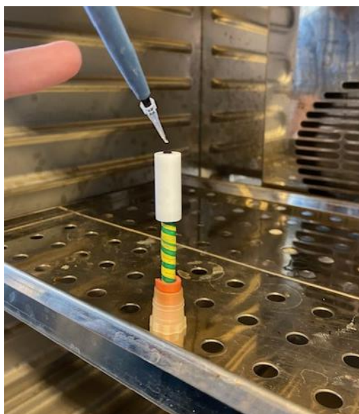
Slika 20 Proces nanošenja kompleksa na GCE
