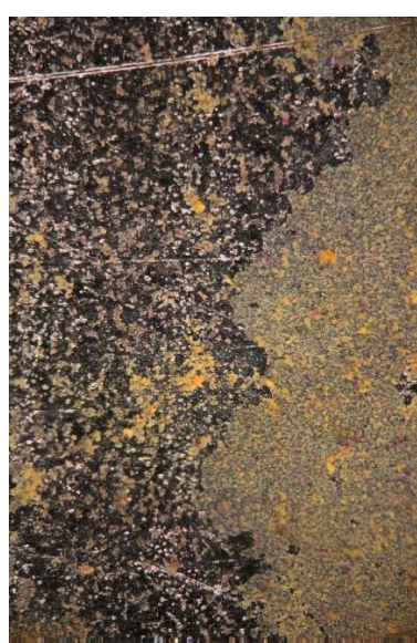
Slika 38. Površina S275 uzorka nakon PD mjerenja u morskoj vodi pri T = 35^{\circ}\text{C} bez inhibitora (a) i uz inhibitor (b).
