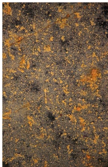
Slika 37. Površina S275 uzorka nakon PD mjerenja u morskoj vodi pri T = 15^{\circ}\text{C} bez inhibitora (a) i uz inhibitor (b).
