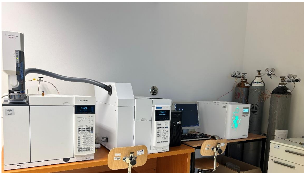
Slika 5. Plinski kromatograf s plameno-ionizacijskim detektorom
