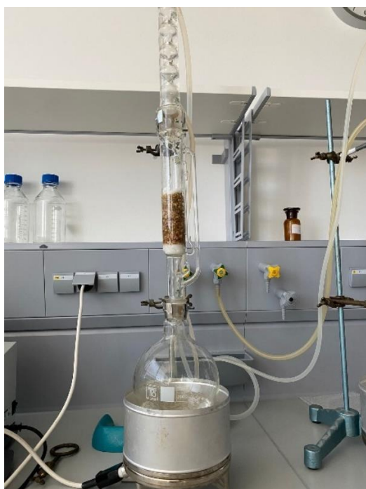
Slika 7. Aparatura za ekstrakciju po Soxhletu (lijevo) i rotacijski vakuum uparivač (desno)
