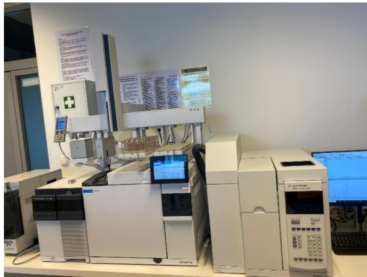
Slika 10. Vezani sustav plinska kromatografija - spektrometrija masa
