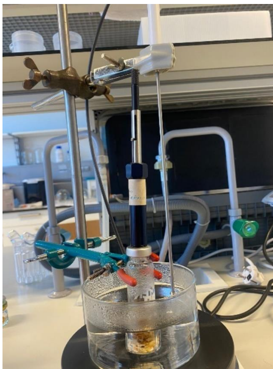
Slika 9. Mikroekstrakcija vršnih para
