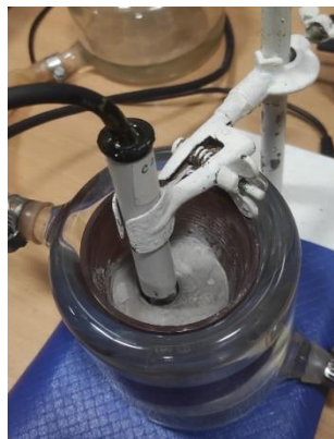
Slika 19. Elektroda za mjerenje specifične električne provodnosti uronjena u uzorak cementne paste
