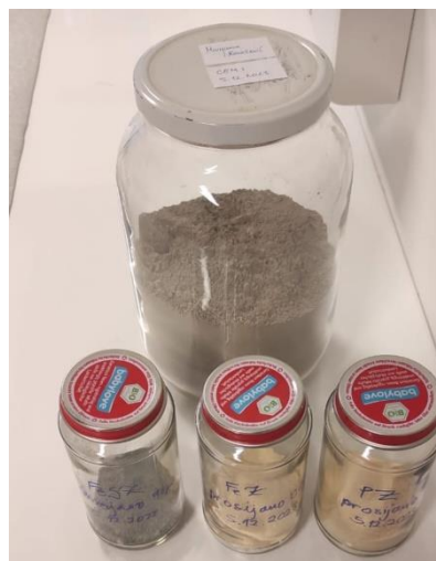
Slika 14. Portland cement i uzorci zeolita
