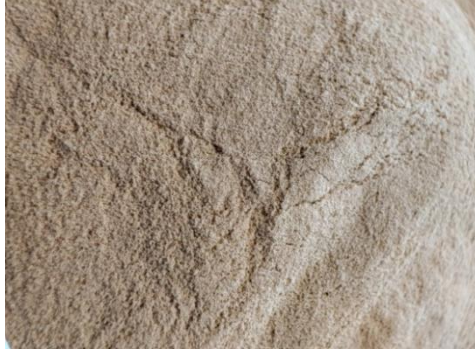
Slika 10. Usitnjeni zeolit NaX veličina čestice između 63 i 90 \mu\text{m}
