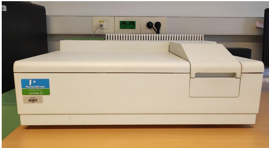
Slika 15. UV/VIS spektrofotometar: Perkin Elmer Lambda 25
