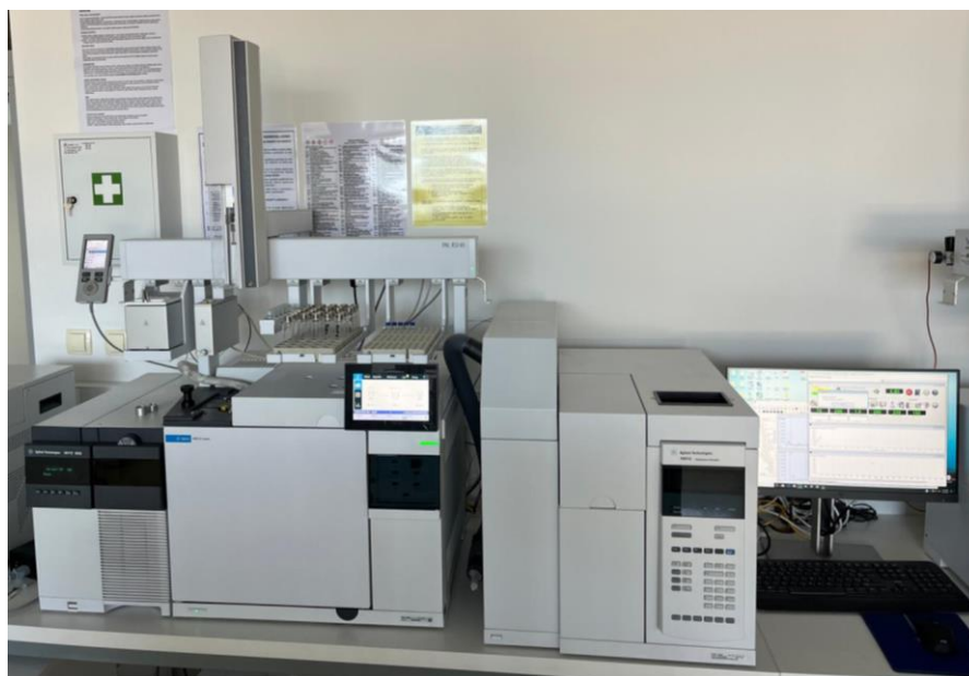
Slika 21. Vezani sustav plinska kromatografija-spektrometrija masa (GC-MS)
