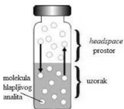
Slika 13. Shematski prikaz headspace uzorkovanja
