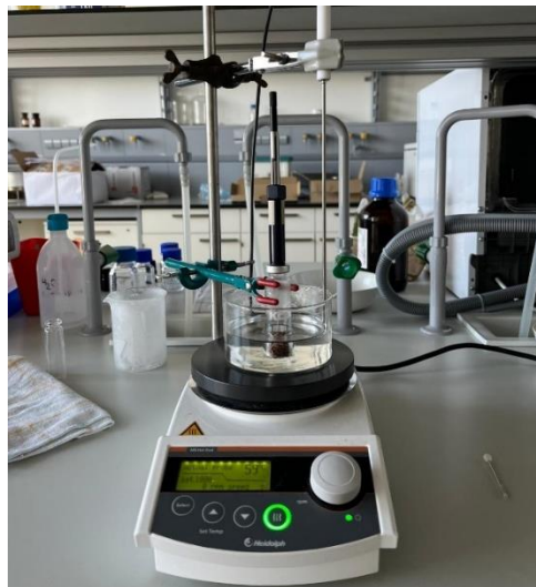
Slika 19. Aparatura za mikroekstrakciju vršnih para na čvrstoj fazi (adsorpcija hlapljivih spojeva)
