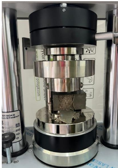
Slika 14. MATEST preša za određivanje tlačne čvrstoće
