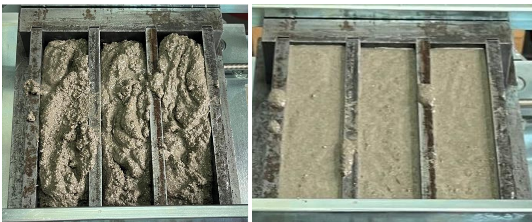
Slika 10. Prvi sloj direktno nanesen iz posude (a), prizme nakon prvog zbijanja (b)
