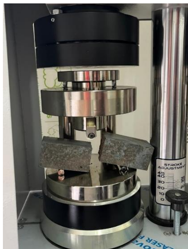
Slika 13. MATEST preša za određivanje savojne čvrstoće
