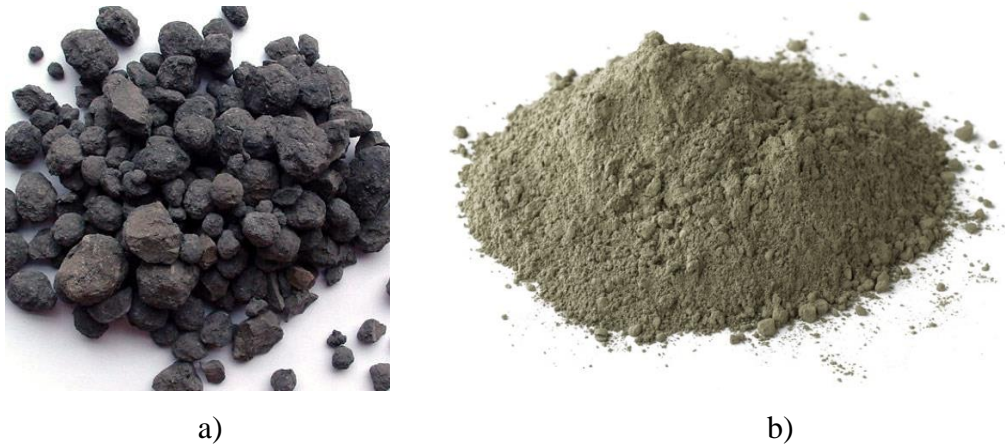
Slika 3. Prikaz cementnog klinkera (a) 9 , samljevani cement (b) 10
