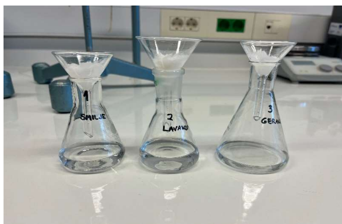
Slika 16. Filtracija preko lijevka
