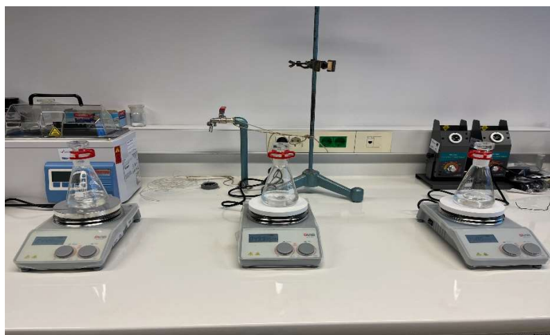
Slika 15. Ekstrakcija miješanjem na magnetskoj mješalici
