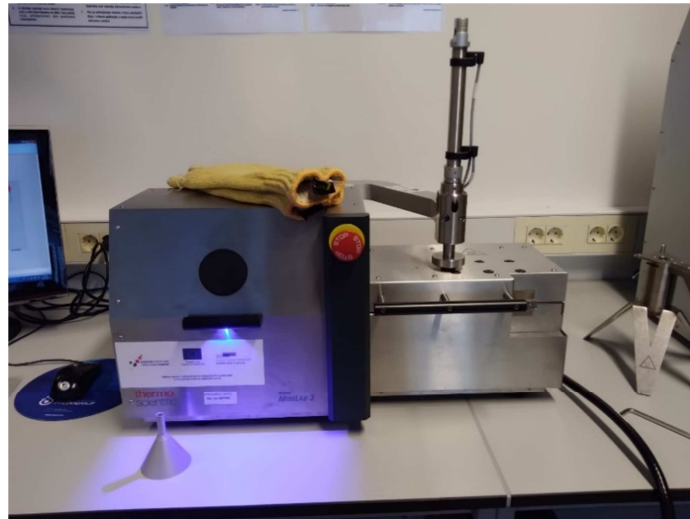
Slika 20. Prikaz ekstrudera HAAKE MiniLab 3 (Thermo Scientific, SAD)
