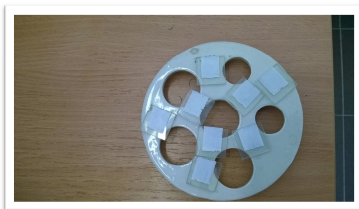
Slika 11. Fiksiranje \text{TiO}_2 paste zagrijavanjem pri T = 400\text{ }^\circ\text{C} , brzina zagrijavanja 10\text{ }^\circ\text{C min}^{-1}
