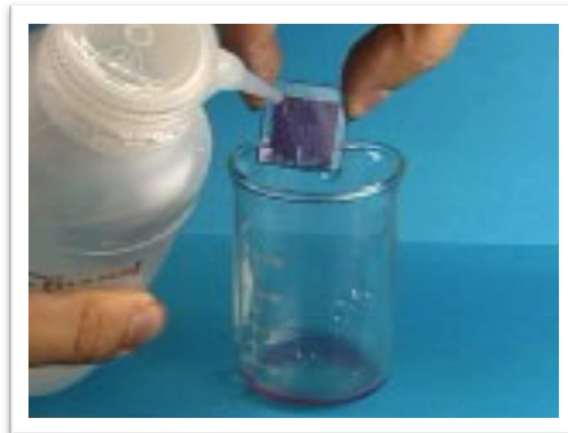
Slika 13. Ispiranje stakalca etanolom
