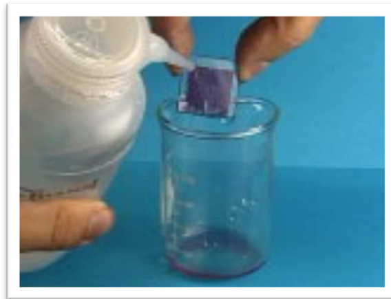
Slika 13. Ispiranje stakalca etanolom
