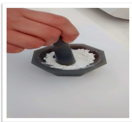
Slika 7. Priprema TiO 2 paste u tarioniku
