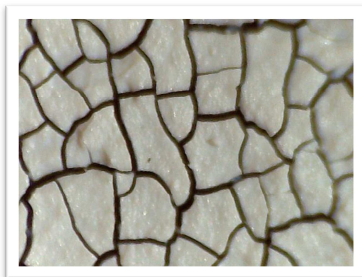
Slika 26. Izgled nanesenog TiO_2 sloja sa nehomogeniziranim nakupinama TiO_2 zrna, povećanje 40X
