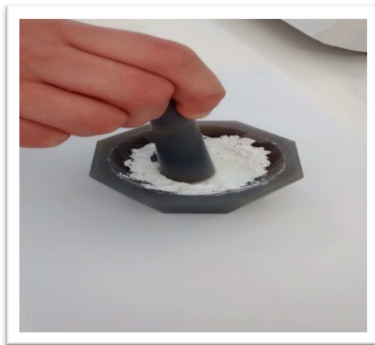
Slika 7. Priprema TiO 2 paste u tarioniku
