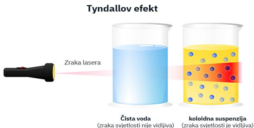
Slika 2. Prikaz pojave Tyndallovog efekta pri prolazu laserske zrake kroz koloidnu suspenziju. 13
