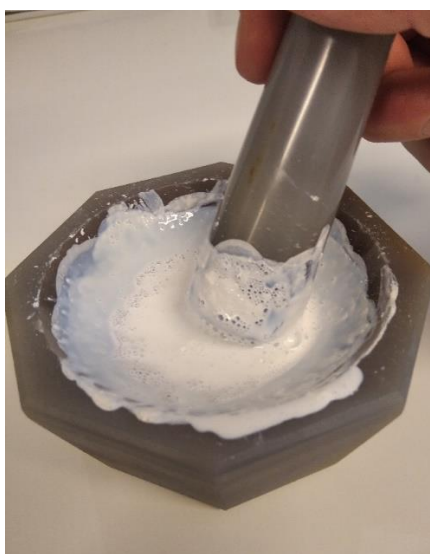
Slika 20. Konzistencija dobivene paste \text{TiO}_2
