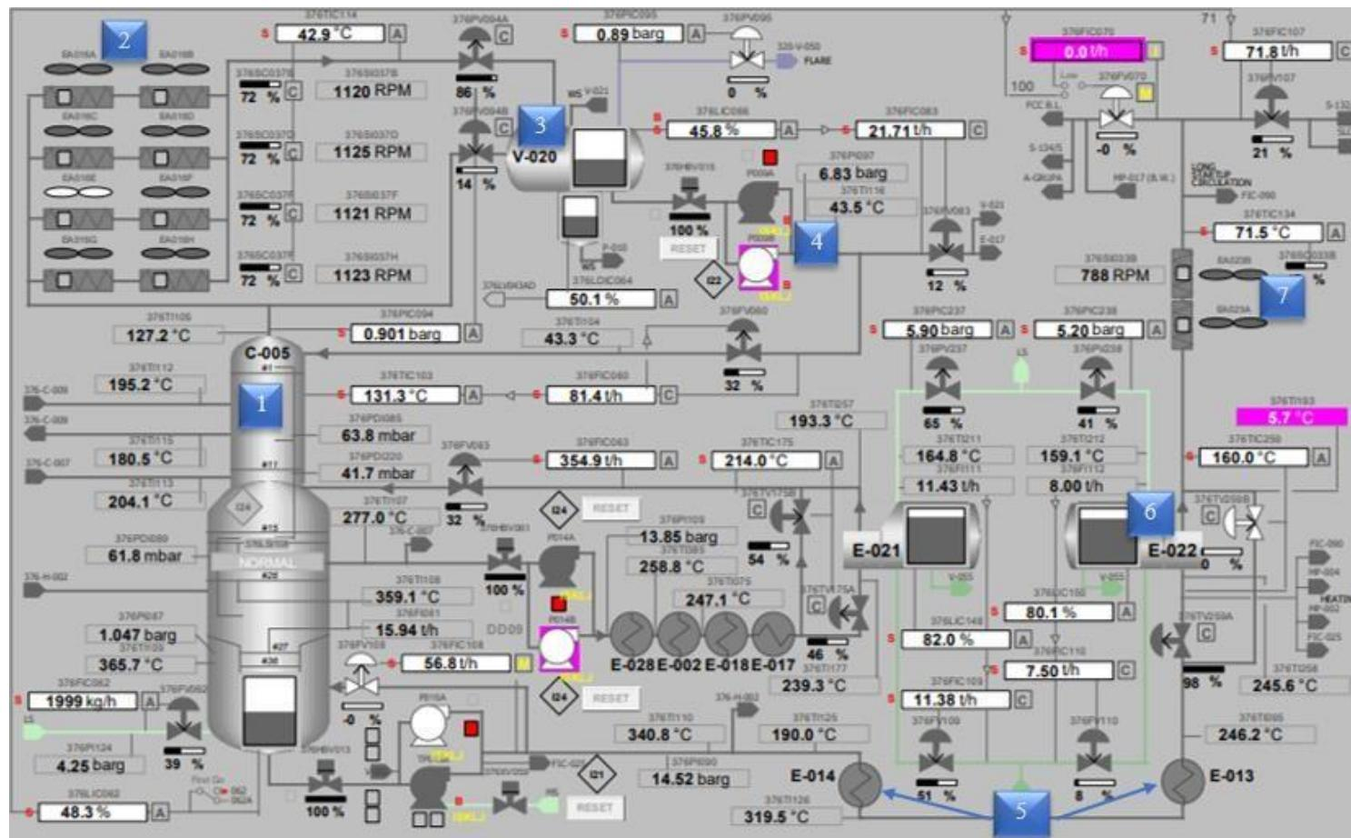
**Slika 10.** Shematski prikaz frakcionacijске sekciјe/frakcionatora:
