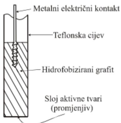
Slika 13. Shematski prikaz CPE<sup>[79]</sup>
