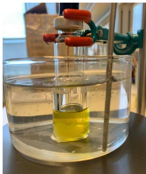
**Slika 20.** Apsorpcija hlapljivih spojeva iz uzorka na vlakno (Izvor: autor)
