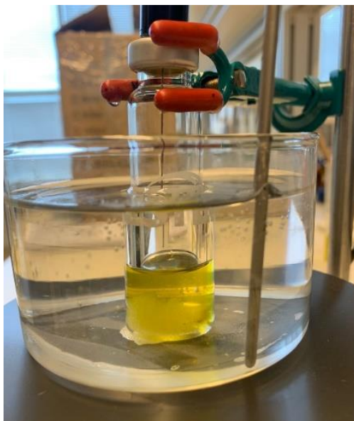
Slika 20. Apsorpcija hlapljivih spojeva iz uzorka na vlakno (Izvor: autor)
