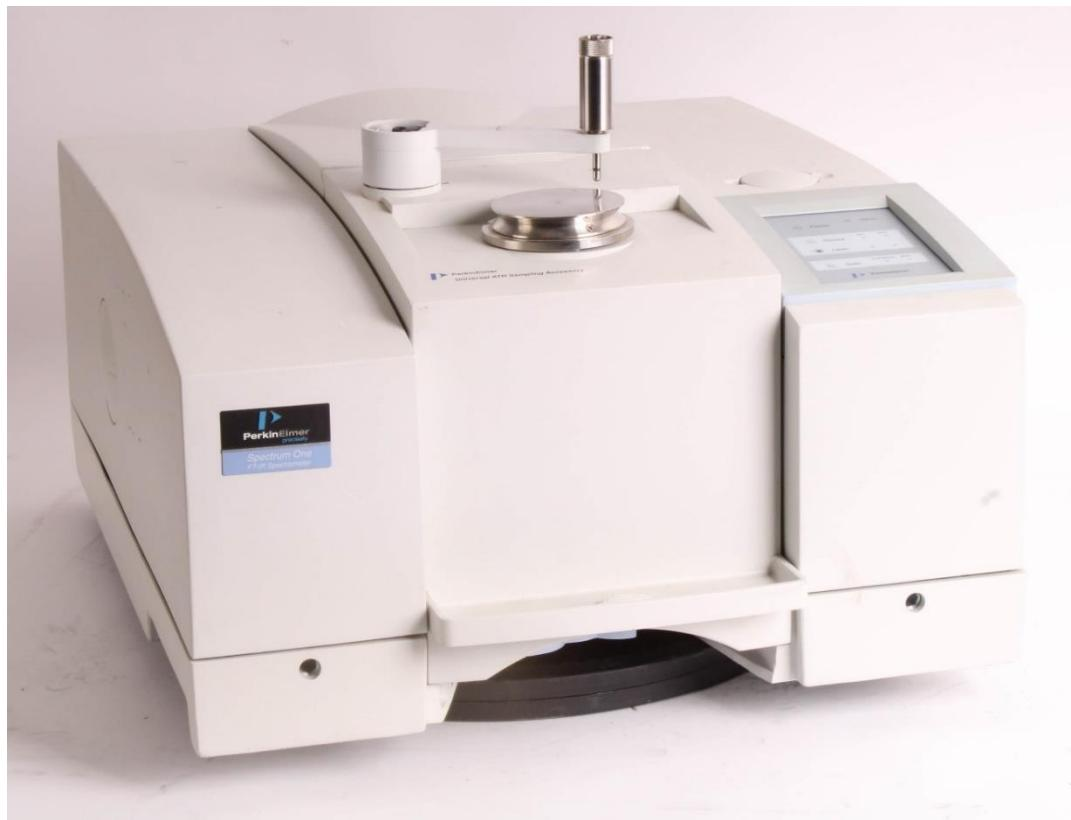
Slika 15. Spectrum One Perkin-Elmer spektrofotometar
