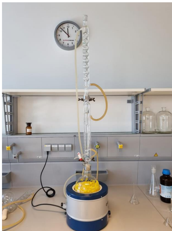
Slika 18. Aparatura za vodenu destilaciju po Clevengeru (modificirana)
