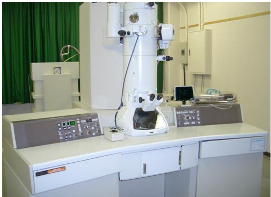
Slika 37. Transmisijski elektronski mikroskop (TEM) model JEM-2010HR
