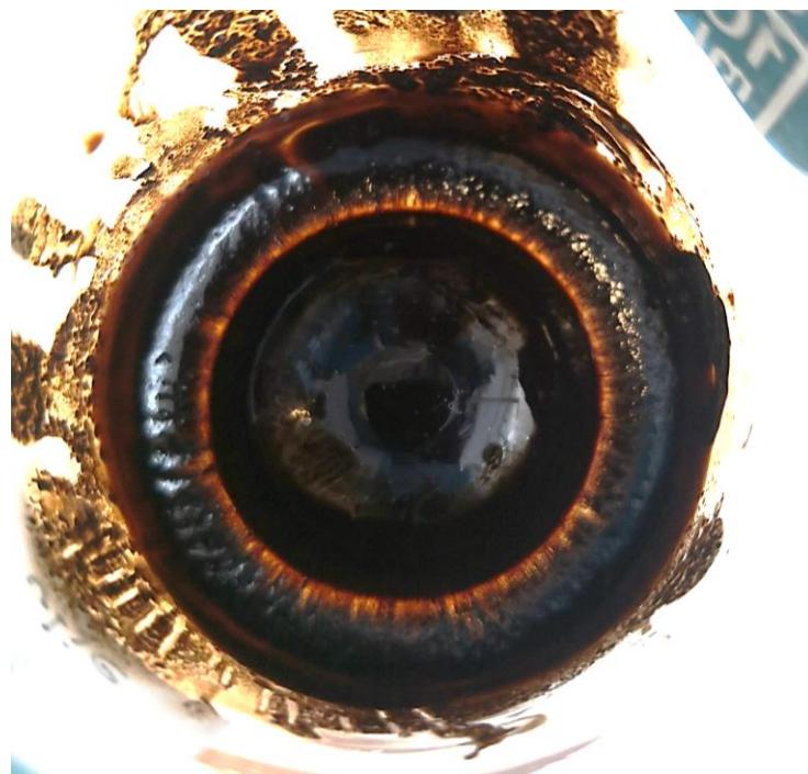
*Slika 28.* Ferofluid pripravljen miješanjem motornog ulja s čvrstim nanomagnetitom
