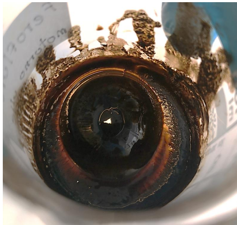
Slika 36. Ferrofluid pripravljen miješanjem motornog ulja s čvrstim nanomagnetitom
