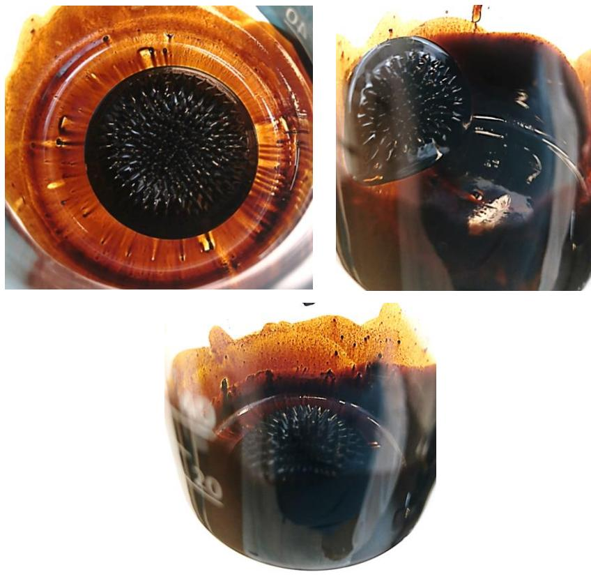
*Slika 31.* Ferofluid pripravljen uz primjenu amonijeva oleata kao surfaktanta i suspendiran s petrolejem
