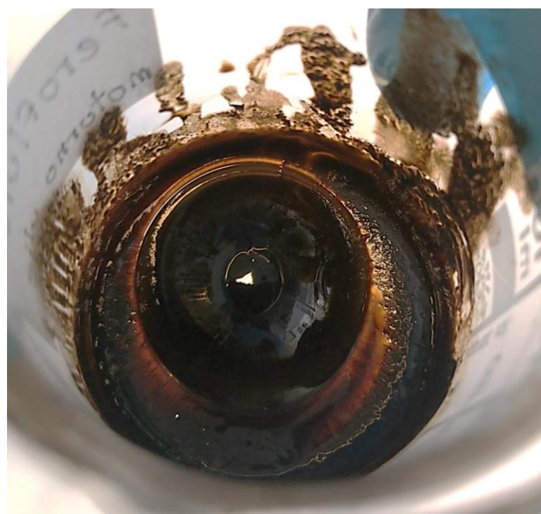
Slika 36. Ferofluid pripravljen miješanjem motornog ulja s čvrstim nanomagnetitom
