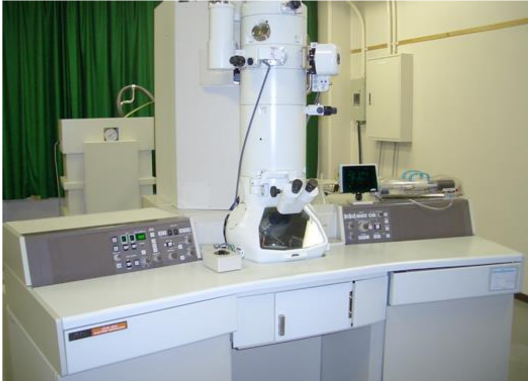
Slika 37. Transmisijski elektronski mikroskop (TEM) model JEM-2010HR
