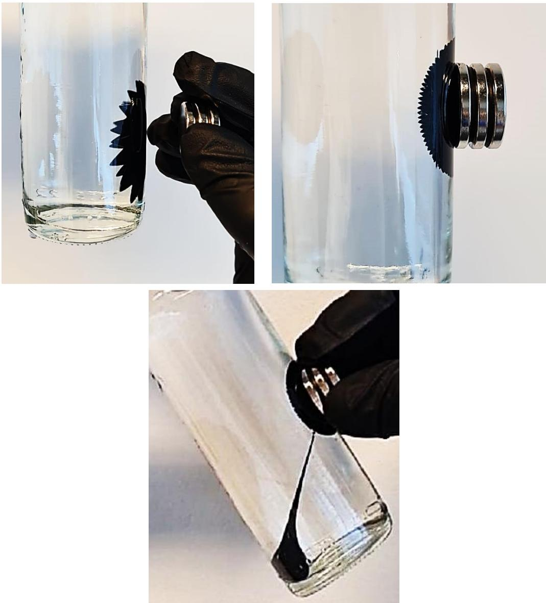
*Slika 33.* Prikaz karakterističnih šiljaka kada je magnet prislonjen uz bočni dio boćice u kojoj se nalazi ferofluid pripravljen s amonijevim oleatom kao surfaktantom
