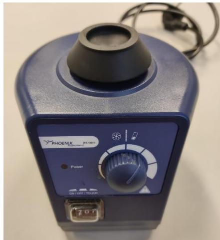
**Slika 4.** Vortex korišten za homogenizaciju testiranih uzoraka bakterijskih stanica (talog) i uzgojnog medija nakon inkubacije (supernatanta) *L. paraplantaruma* (vlastita fotografija)
