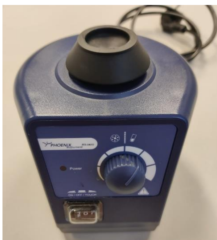
Slika 4. Vortex korišten za homogenizaciju testiranih uzoraka bakterijskih stanica (taloga) i uzgojnog medija nakon inkubacije (supernatanta) L. paraplantaruma (vlastita fotografija)
