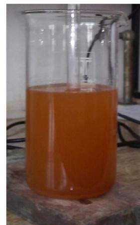
Slika 18. Obrada filtrata izopropanolom s omjerom 2 : 1 u odnosu na dobiveni filtrat (dupo više izopropanola), uz miješanje 2 sata pri sobnoj temperaturi.
