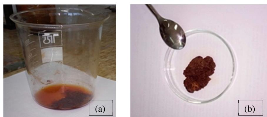
Slika 20. Ispiranje dobivene karuba gume dva puta izopropanolom (a), karuba guma nakon sušenja pri sobnoj temperaturi (b).
