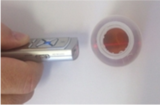
Slika 27. Provjera pojave Tyndallovog efekta u sintetiziranom uzorku koloidnog srebra, pogled odzgo i sa strane.
