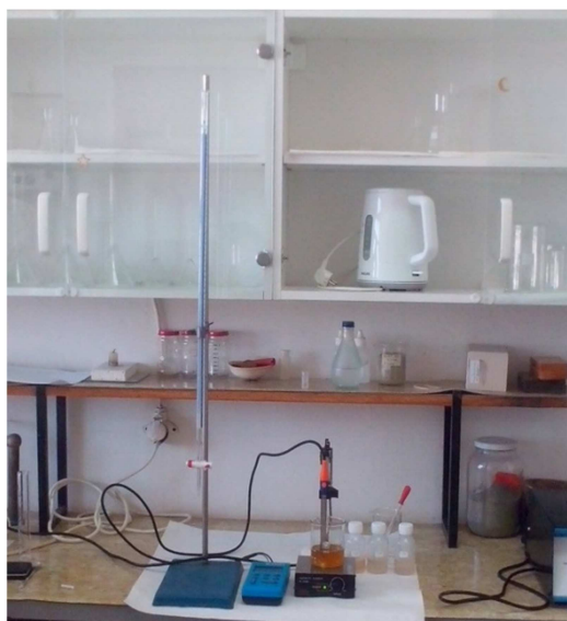
Slika 21. Aparatura za dobivanje koloidnog srebra, sastoji se od: konduktometra, pH metra Schott Handylab LF 11, magnetska miješalica, te čaše s uzorkom.
