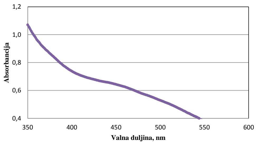
Slika 32. UV-Vis spektrogram koloidnog srebra dobivenog redukcijom pomoću meda pri pH vrijednosti 8,0.
