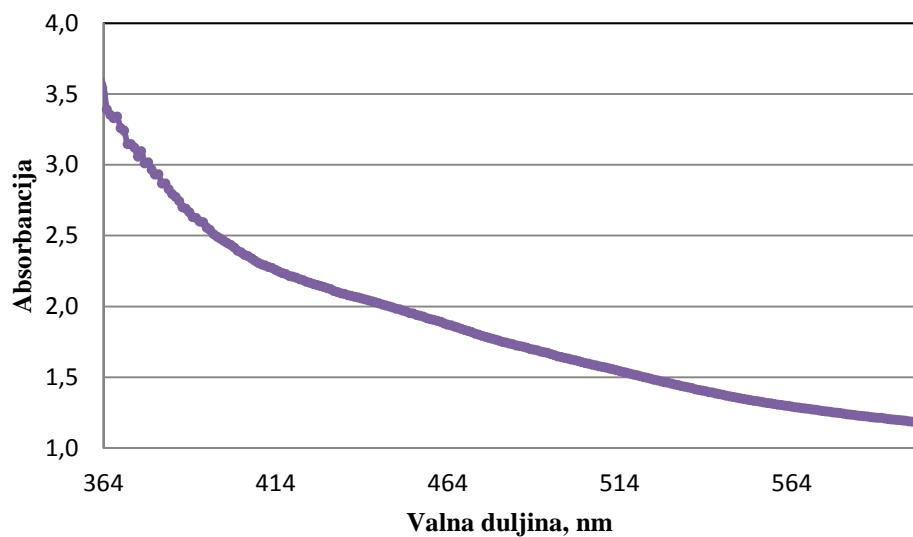
Slika 35. UV-Vis spektrogram koloidnog srebra dobivenog redukcijom pomoću meda pri pH vrijednosti 8,0 i uz dodatak 5% karuba gume.
