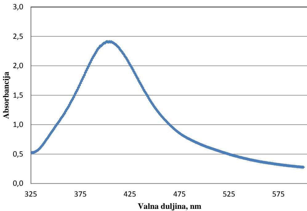
Slika 28. UV-Vis spektrogram koloidnog srebra dobivenog redukcijom  $\text{AgNO}_3$  pomoću  $\text{NaBH}_4$ .
