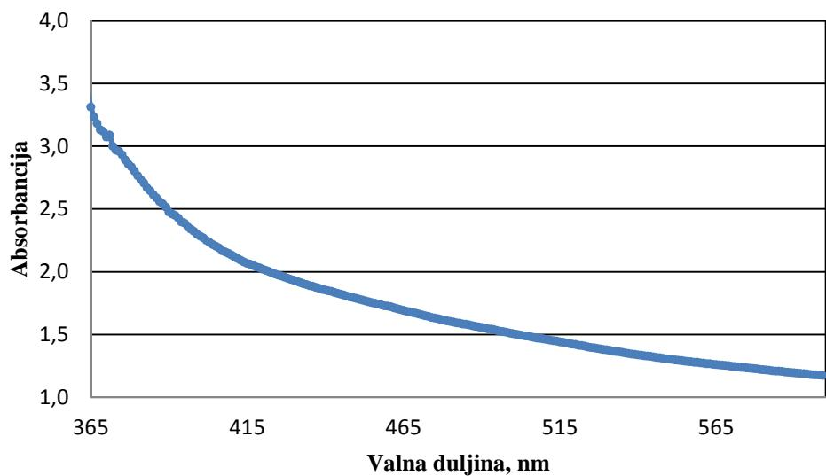
Slika 33. UV-Vis spektrogram koloidnog srebra dobiven redukcijom pomoću meda pri pH vrijednosti 6,5 i uz dodatak 5 % karuba gume.
