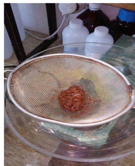
Slika 19. Dobivena karuba guma nakon filtracije kroz metalno sito
