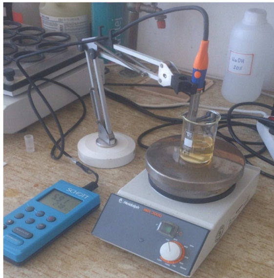
Slika 21. Aparatura za dobivanje koloidnog srebra, sastoji se od: konduktometra, pH metra Schott Handylab LF 11, magnetska miješalica, te čaše s uzorkom.
