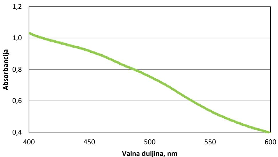
Slika 31. UV-Vis spektrogram koloidnog srebra dobivenog redukcijom pomoću meda pri pH vrijednosti 7,5.
