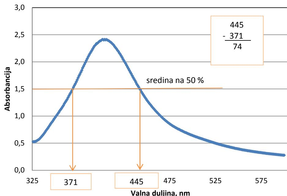
Slika 38. Prikaz očitanja PWHM, nm, za standardni uzorak
