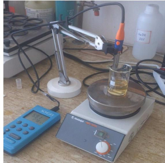
*Slika 21. Aparatura za dobivanje koloidnog srebra, sastoji se od: konduktometra, pH metra Schott Handylab LF 11, magnetneska miješalica, te čaše s uzorkom.*
