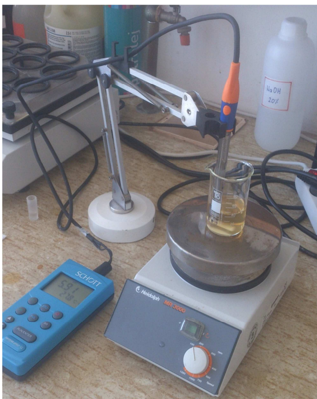
Slika 3. Aparatura za dobivanje koloidnog srebra
