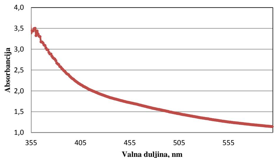
Slika 34. UV-Vis spektrogram koloidnog srebra dobiven redukcijom pomoću meda pri pH vrijednosti 7,0 i uz dodatak 5 % karuba gume.
