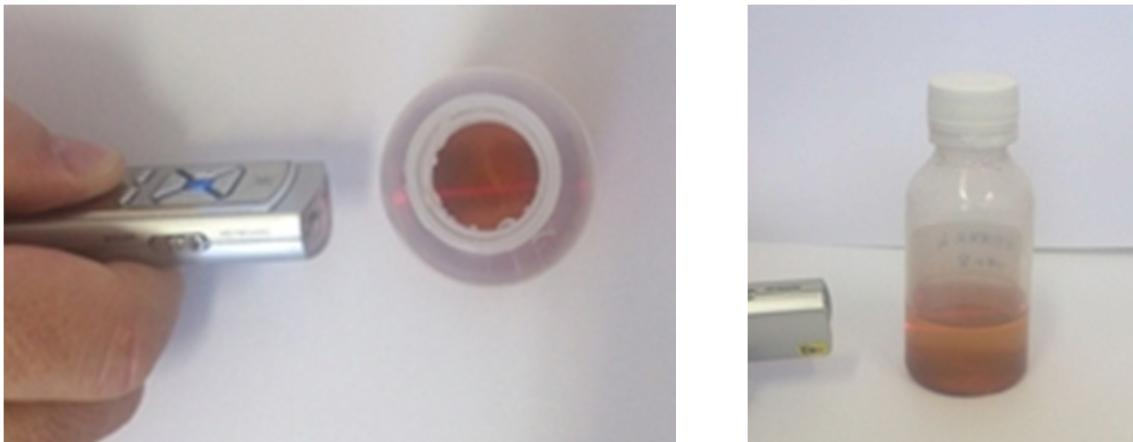
*Slika 27. Provjera pojave Tyndallovog efekta u sintetiziranom uzorku koloidnog srebra, pogled odzgo i sa strane.*
