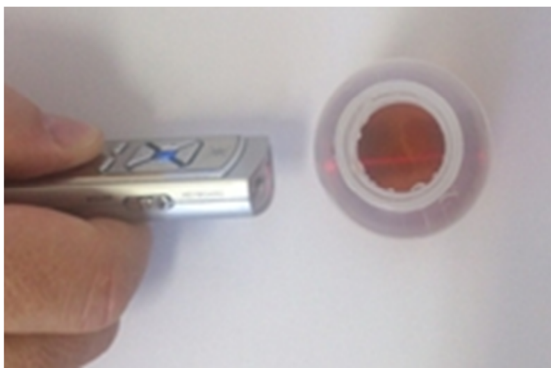
Slika 4. Tyndallov efekt pri prolasku laserske zrake kroz koloidne
