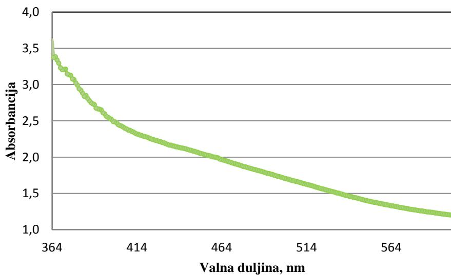
Slika 34. UV-Vis spektrogram koloidnog srebra dobiven redukcijom pomoću meda pri pH vrijednosti 7,5 i uz dodatak 5% karuba gume
