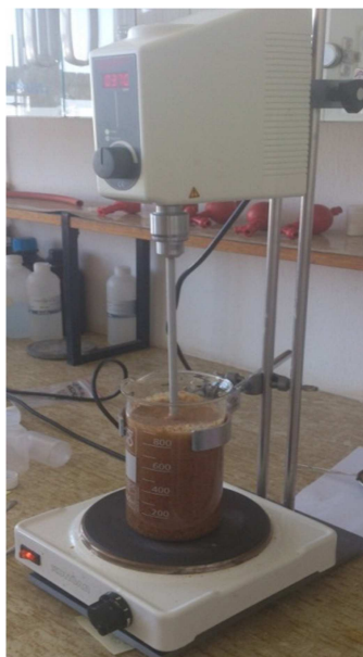
Slika 15. Zagrijavanje pulpe sjemenke rogača, uz dodatak 2800 mL vode, pri 80 °C, 30 minuta.
