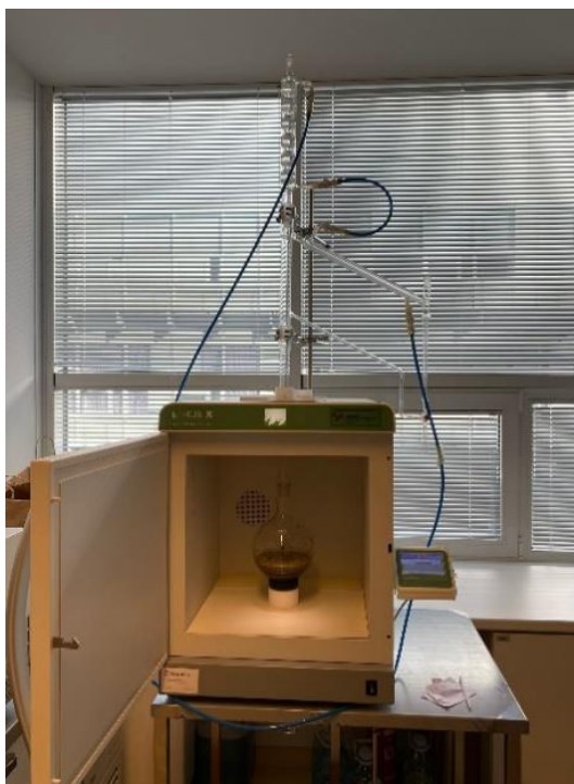
Slika 9. Mikrovalovima potpomognuta destilacija
